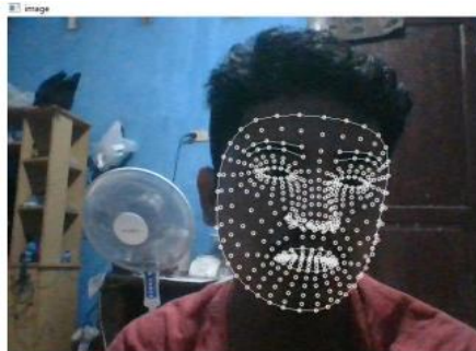
Gambar 2. Facial Landmark Dengan Facemesh Model
