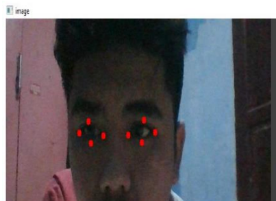
Gambar 3. Pendeteksian Kedipan Dengan EAR
