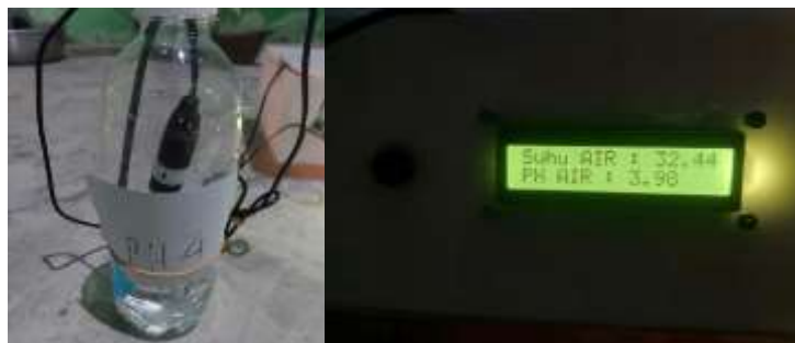
Gambar 6. Pengujian Alat dengan Nilai Ph 4 dan Suhu 32°C
