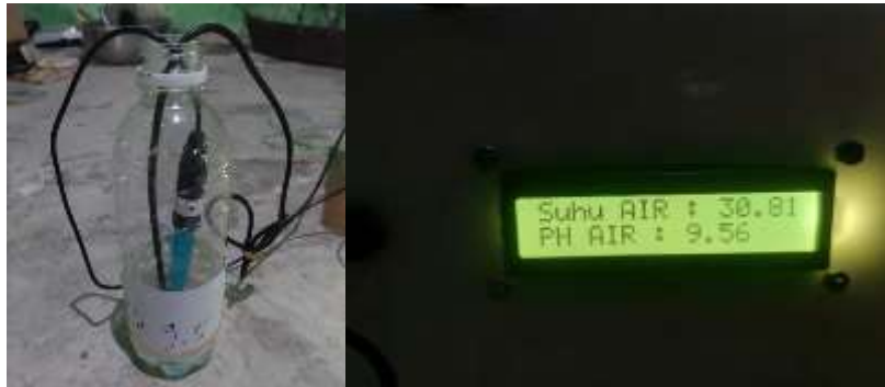
Gambar 8. Pengujian dengan Alat Nilai Ph 9,5 dan Suhu 30°C
