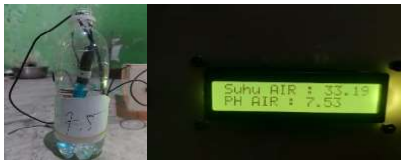
Gambar 7. Pengujian Alat dengan Nilai Ph 7.5 dan Suhu 33°C
