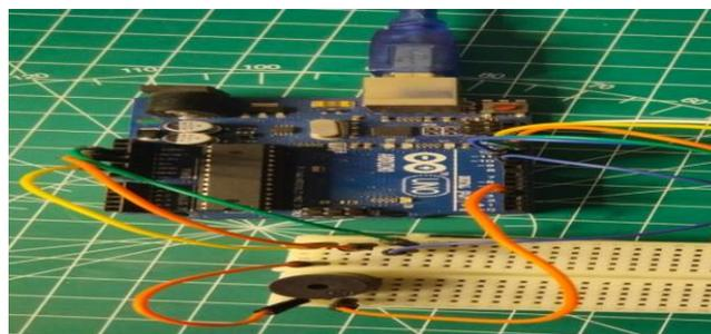
Gambar 7 Rangkaian Arduino dan Buzzer
