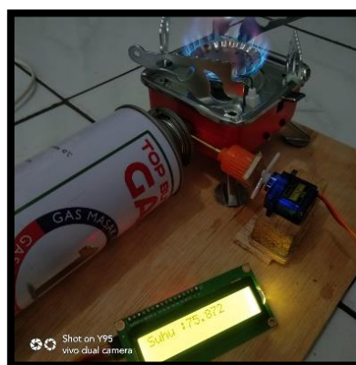
Gambar 8. Kondisi Posisi Servo 70
