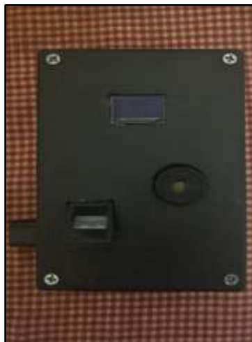
Gambar 5. Tampilan Modul Perangkat Keras Sistem Absensi
