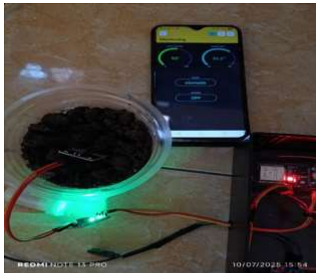
Gambar 9. kondisi tanah kering dan kecepatan pompa sedang
