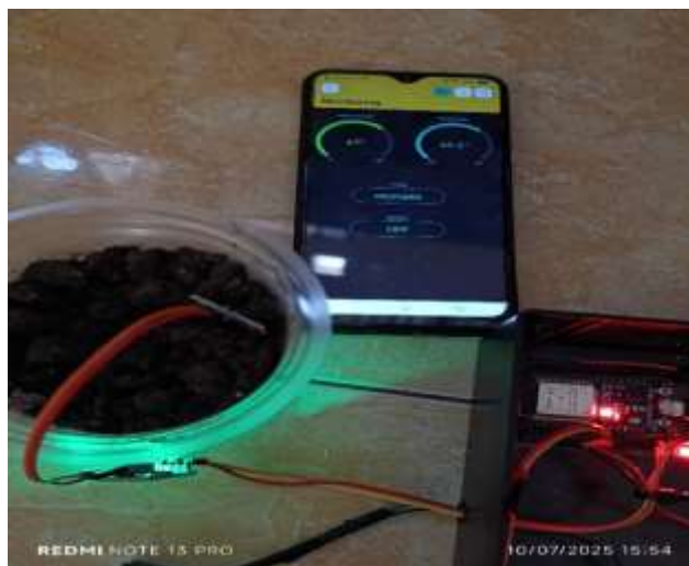
Gambar 10. kondisi tanah lembab dan pompa mulai pelan
