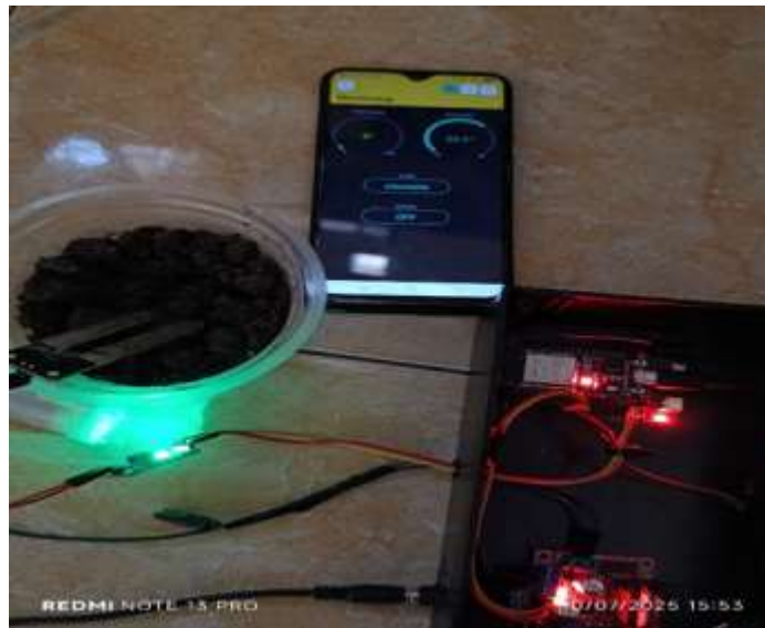
Gambar 8. kondisi tanah sangat kering dan pompa sangat cepat
