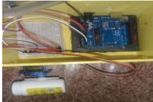
Gambar 8. Rangkaian Arduino Uno Dengan Motor Servo
