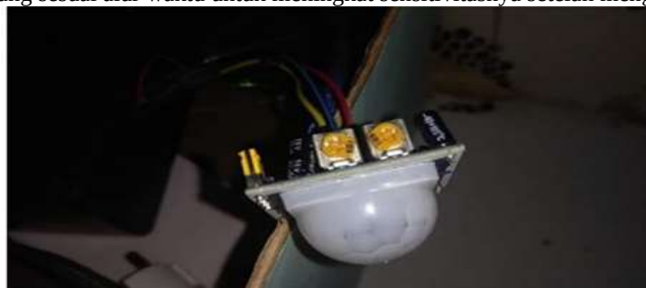
Gambar 13 Pengatur sensitivitas pada snsor PIR
