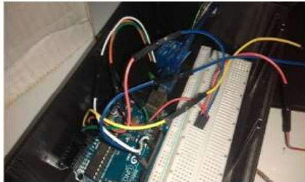
Gambar 10 Pin GND Relay dan sensor ke GND Arduino
