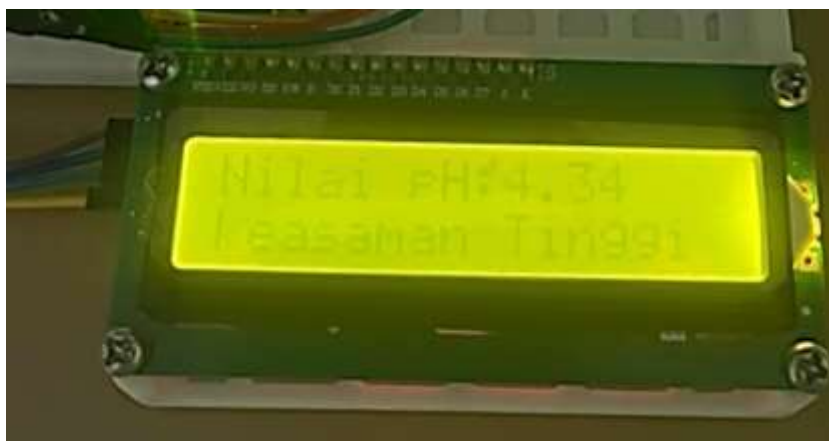
Gambar 13. LCD Menunjukkan Keasaman Tinggi
