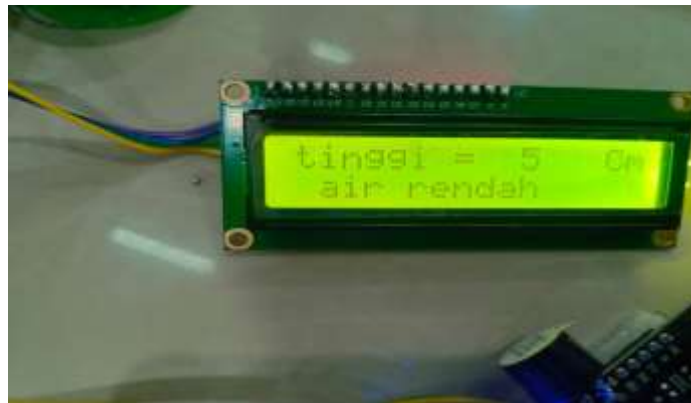
Gambar 6. Pengujian LCD kondisi Air Rendah
