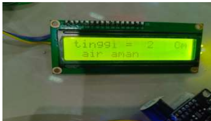
Gambar 7. Pengujian LCD kondisi air aman
