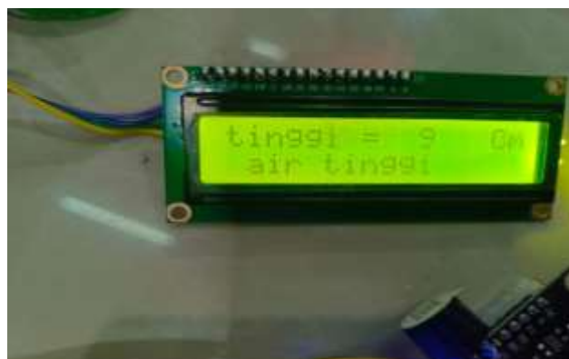
Gambar 5. Pengujian LCD Kondisi Air Tinggi
