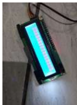
Gambar 10. Rangkaian LCD I2C 16x2
