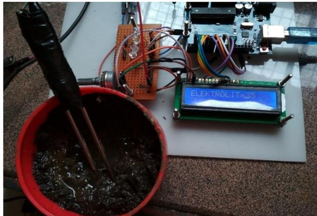
Gambar 10 Pengujian Sensor Elektrolit
