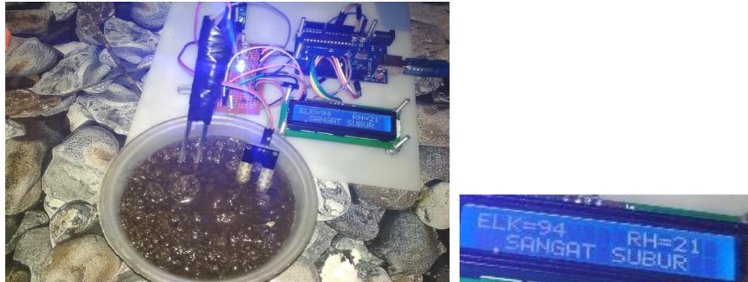
Gambar 13 Pengujian Pada Sample Tanah (3)
