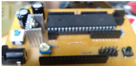
Gambar 9. Sistem Kendali Utama Berbasis ATmega8535
