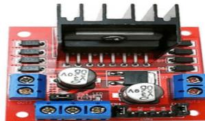
Gambar 5. IC L298 & Modul Driver Motor L298N
