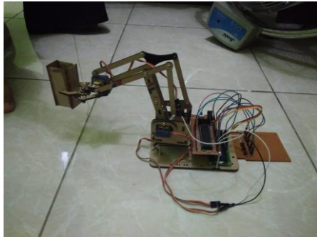
Gambar 5.1 : Robot Saat Menjapit Benda
