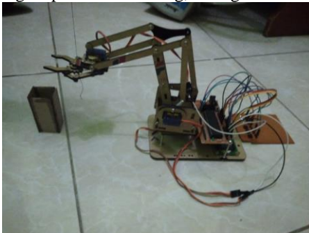
Gambar 5.2 : Robot Saat Melepas Benda
