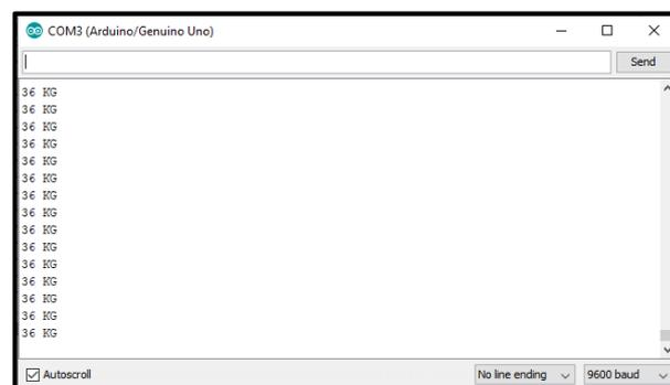
Pada gambar diatas dapat dilihat bahwa ketika sensor mendeteksi adanya beban dari tabung oksigen tersebut maka sensor akan membaca data yang menghasilkan kondisi dari tabung berupa berat yang jika range  $\geq 25$  kg maka kondisi dari tabung oksigen sedang dan *buzzer* mati.
