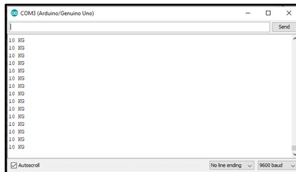
Pada gambar diatas dapat dilihat bahwa ketika sensor mendeteksi adanya beban dari tabung oksigen tersebut maka sensor akan membaca data yang menghasilkan kondisi dari tabung berupa berat yang jika range  $\geq 0$  kg maka kondisi dari tabung oksigen sudah habis dan *buzzer* hidup berdurasi cepat.
