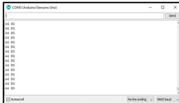
Pada gambar diatas dapat dilihat bahwa ketika sensor mendeteksi adanya beban dari tabung oksigen tersebut maka sensor akan membaca data yang menghasilkan kondisi dari tabung berupa berat yang jika range  $\geq 40$  kg maka kondisi dari tabung oksigen masih penuh dan *buzzer* mati.
