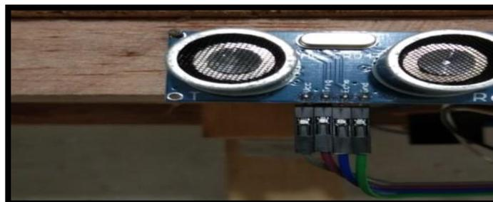
Gambar 9. Rangkaian Sensor Ultrasonik
