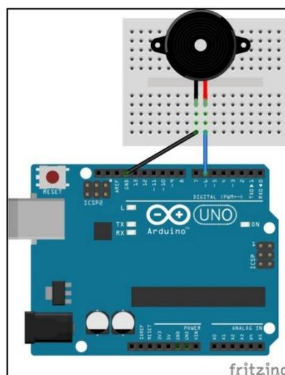
Gambar 3.9 Rangkaian *Buzzer*
