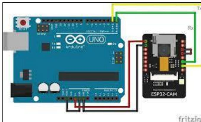
Gambar 3.6Rangkaian ESPCAM
