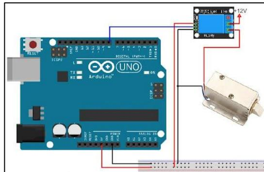
Gambar 3.8 Rangkaian solenoid
