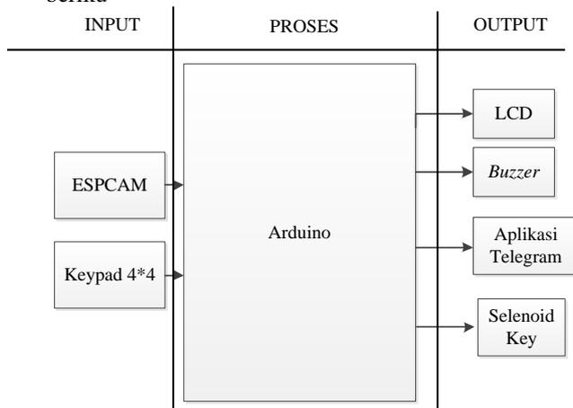
Gambar 3.1 Blok Diagram Sistem
