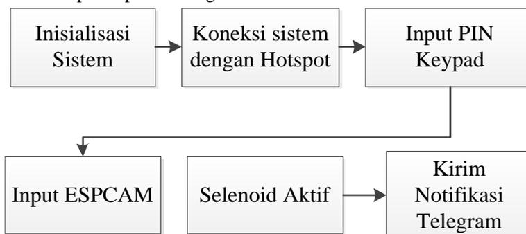
Gambar 3.2 Algoritma Sistem
