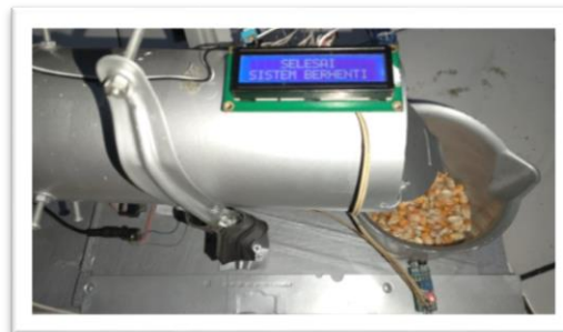
Gambar 10 Proses Jagung Terdeteksi Penuh Oleh Sensor Photodiode 2
