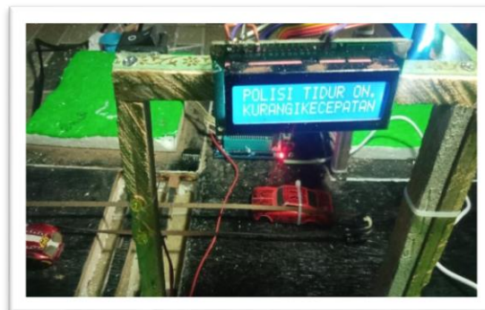
Gambar 8 Proses Tampilan LCD Di Simpang 1 Dan Simpang 2
