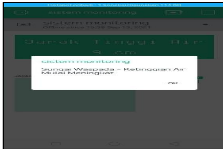
Gambar 10. Notifikasi Ketinggian Air Sungai Dalam Kondisi Waspada
