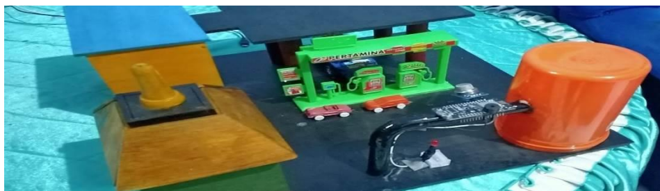
Gambar 3.5 Prototype Sistem Monitoring Kebocoran Pipa Gas Pada SPBE
