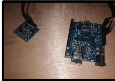
Gambar 5.2 Rangkaian RTC DS1307 dan Arduino
