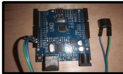
Gambar 5.3 Rangkaian Buzzer dan Arduino
