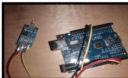
Gambar 5.1 Gambar Rangkaian Photodiode dan Arduino
