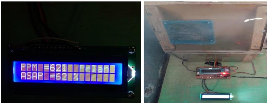
Gambar 10 Kondisi Ruangan Terdeteksi Asap Dengan Fan Pelan
