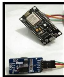
Gambar 8 Module RTC DS3231
