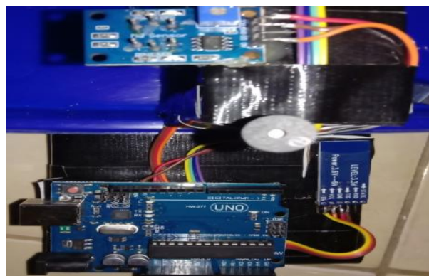
Gambar 9. Rangkaian Sensor Gas MQ135
