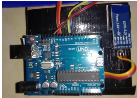
Gambar 8. Rangkaian Modul Bluetooth HC-05
