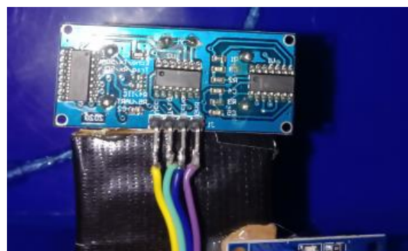
Gambar 10 Rangkaian Sensor Ultrasonik
