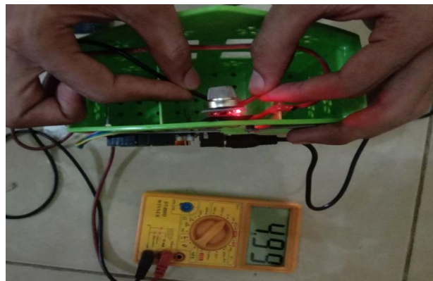
Gambar 6. Pengujian Tegangan Sensor gas MQ135
