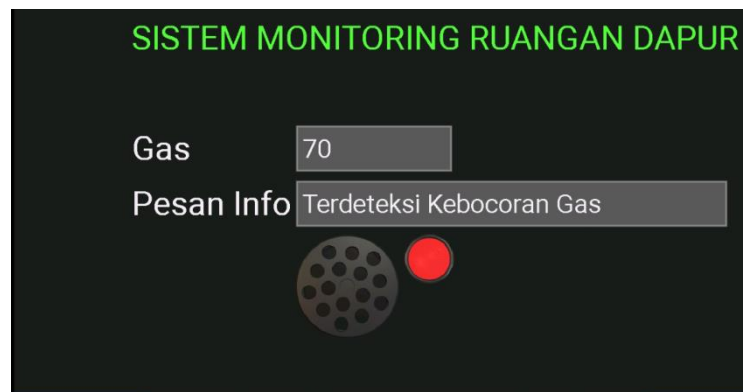
Gambar 8. Pengujian Tampilan Pada Smartphone Kondisi Terdeteksi Kebocoran Gas
