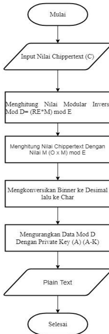
Gambar 3.3 Flowchart Dekripsi Algoritma Sistem
