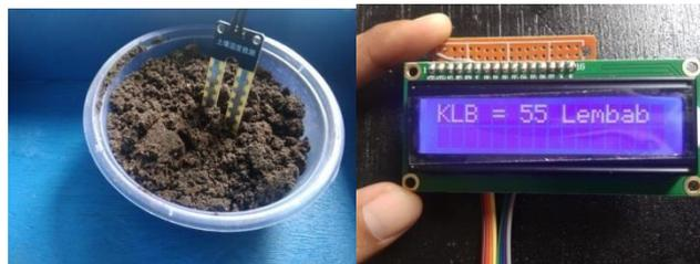
Gambar 5.7 Pengujian Sensor Kelembaban Tanah
