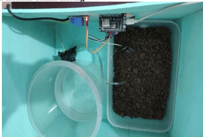
Gambar 9. Pengujian Sensor pada kondisi tanah kering
