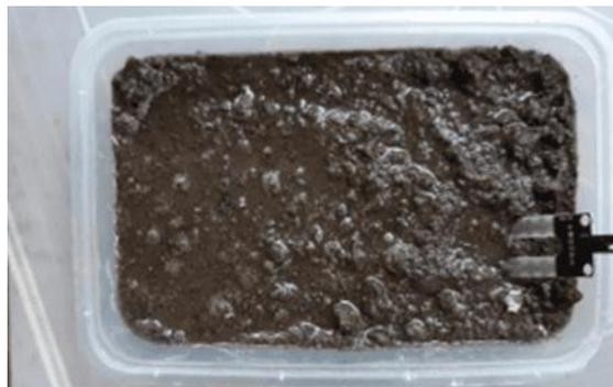
Gambar 11. Pengujian Pada Tanah Basah
