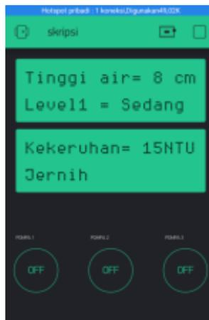
Gambar 9 Pengujian LCD Pada Tampilan Blynk
