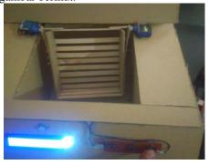
Pada saat penggorengan sistem akan menghitung dengan waktu yang telah di tentukan. Setelah perhitungan selesai servo secara otomatis servo akan kembali ke posisi awal dan ikan pun sudah matang
