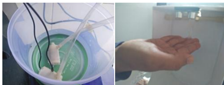
Gambar 12 Pengujian Pompa Air DC
