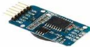
Pada gambar di atas adalah contoh RTC (*Real Time Clock*) untuk mengatur pewaktu agar penjadwalan keaktifan sesuai dengan yang diinginkan.
