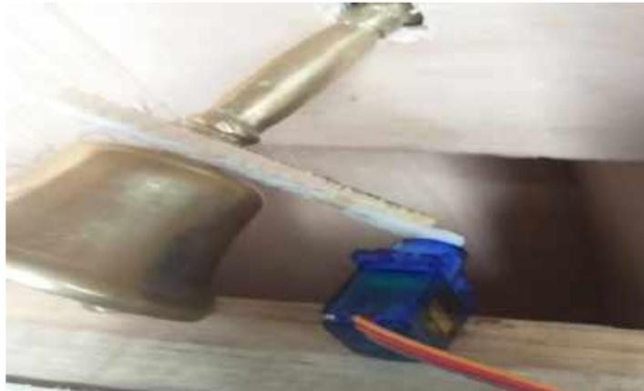
Pengujian Motor Servo Pada Lonceng
