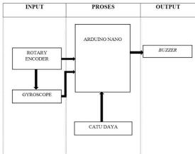
Gambar 3 Blok Diagram
