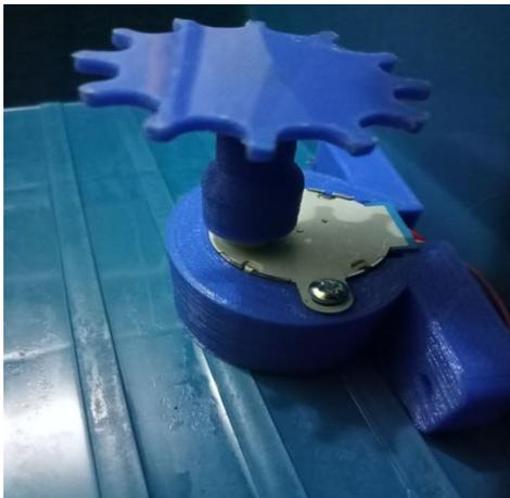
Gambar 5.5 Tampilan Rangkaian *Motor Stepper*
