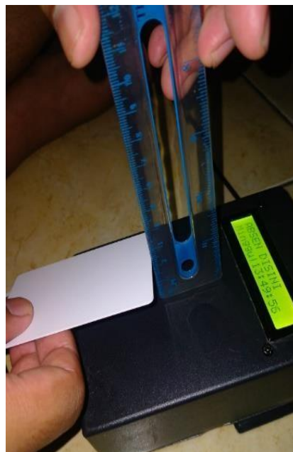
Gambar 11. Proses Pengujian Modul RFID dan LCD
