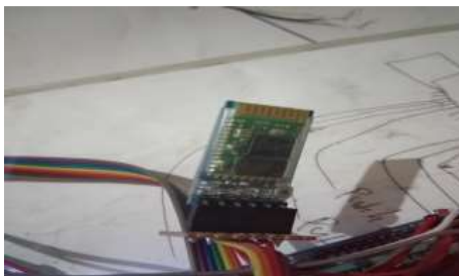
Gambar 3: Hasil rangkaian dari pada modul Bluetooth HC 05
