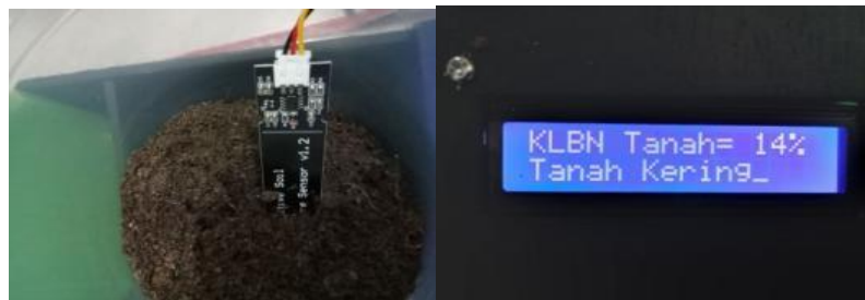
Gambar 11. Pengujian Tanah Kelembaban Kering
